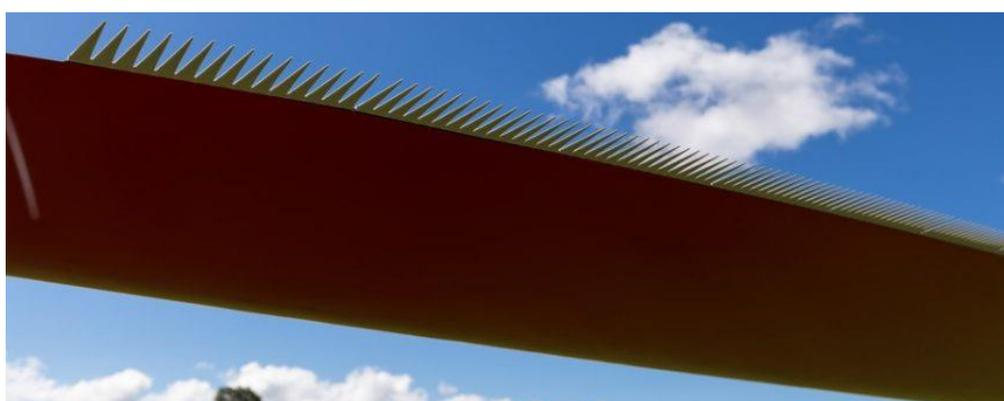
*Figure 4 : Illustration de serration sur le bord de fuite d'une pale (source : energie-partagee.org, 2021)*
